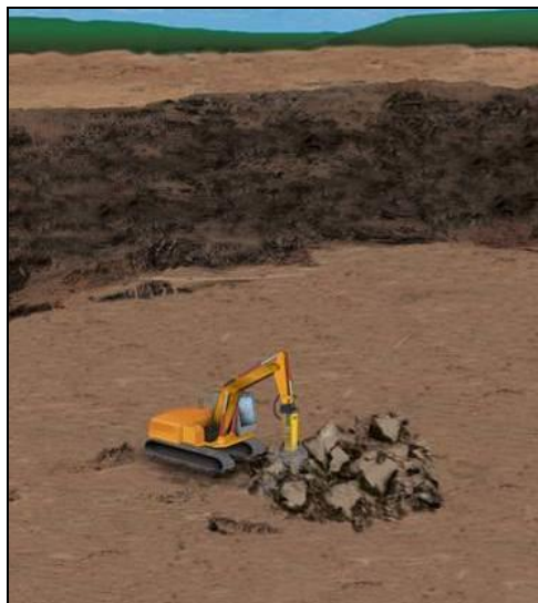
Слика 6. - Уситњавање негабарита механичким ударним чекићем
