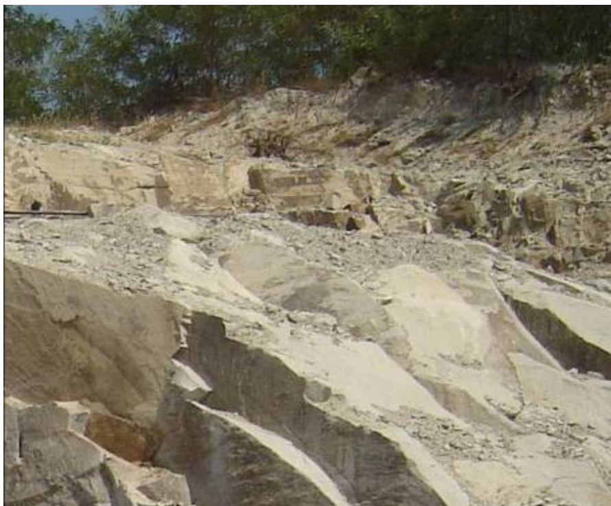
Slika 2. Profil stenske mase u ležištu Visoka–humus, grusificiran, alterisan i kompaktni andeziti (S. Aničić)
