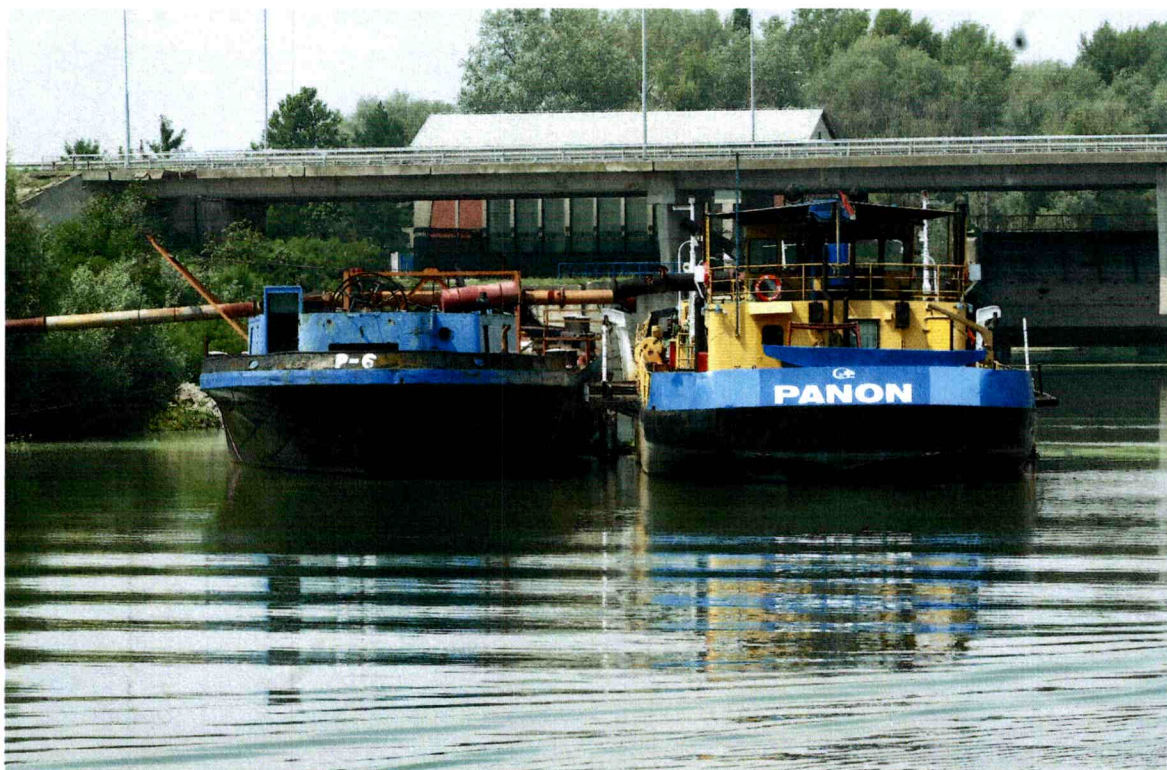
Plovni refulerni bager Mačva za vreme istovara peska
