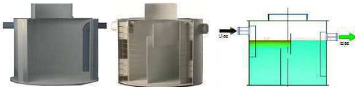
Слика 23. – Изглед, попречни пресек и принцип рада сепаратора
