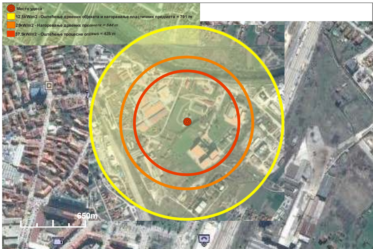
Slika 7.2.2. Rasprostiranje termalne radijacije pri najgorem mogućem efektu BLEVE (propan)
