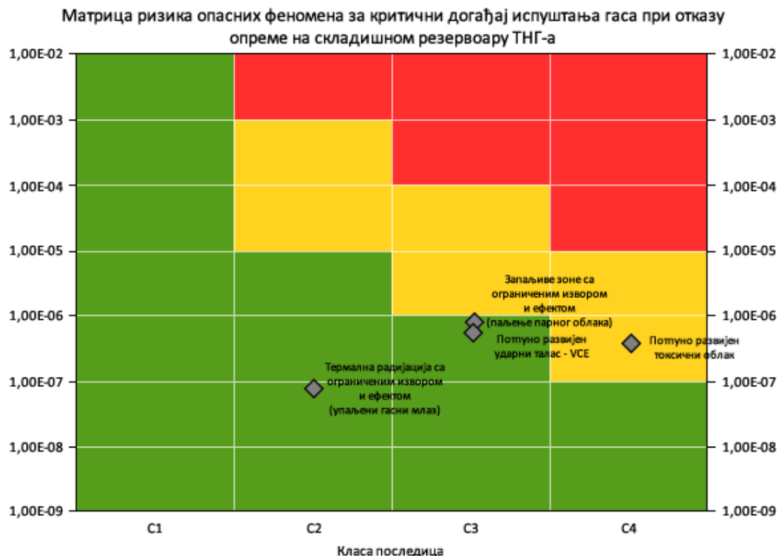
Slika 7.1.3. Matrica rizika opasnih fenomena za kritični događaj ispuštanja gasa pri otkazu opreme na skladišnom rezervoaru sa TNG-om
