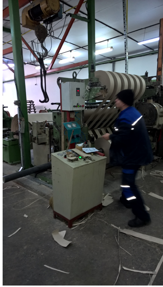
Приказ сечења готовог производа на задату величину
