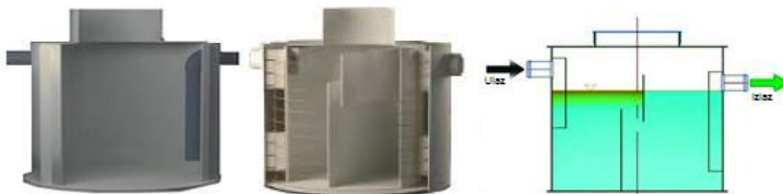
Слика 18. – Изглед, попречни пресек и принцип рада сепаратора
