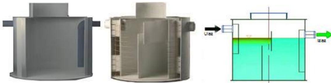
Слика 19. – Изглед, попречни пресек и принцип рада сепаратора
