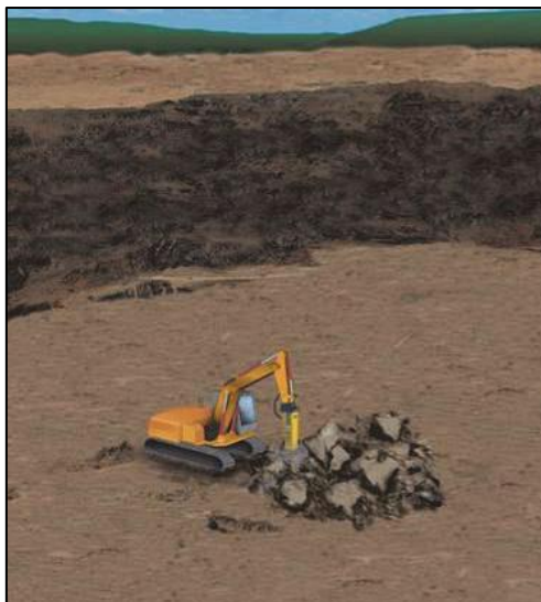
Слика 22. – Уситњавање негабарита механичким ударним чекићем
