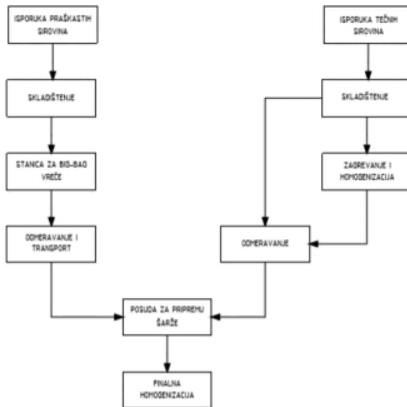
Slika 8. Blok šema proizvodnje praškaste faze kapsula za pranje sudova
