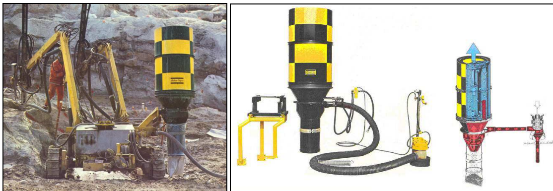
Слика 3. 11. – Отпрашивач DCD 90 са филтером и сувим циклоном у раду
