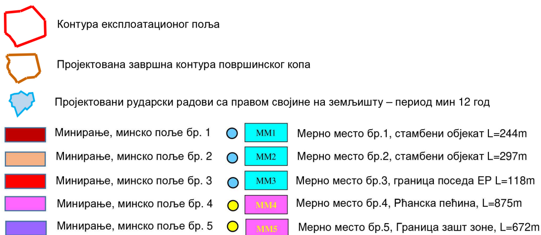
Слика 6.4. – Приказ пробних минирања са мерним местима и удаљености мерних места од минирања
