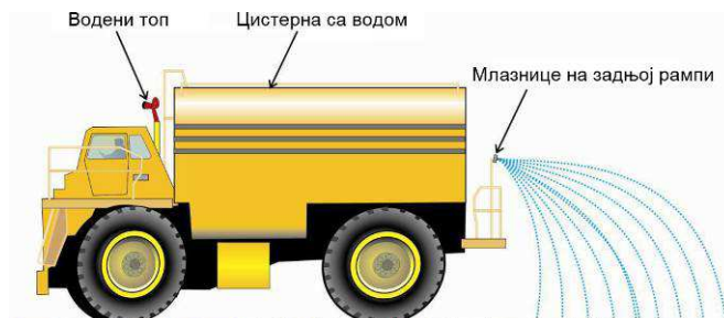
Слика 3. 13. – Аутоцистерна опремљена пумпом, предњим топом и задњом рампом са млазницама
