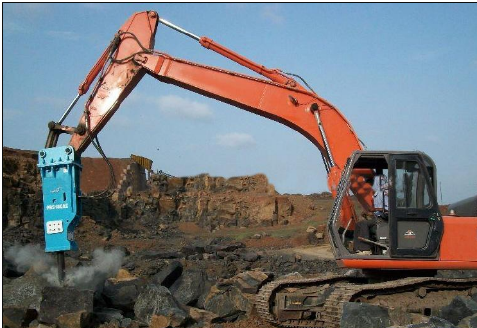
Слика бр. 21: Уситњавање негабарита механичким ударним чекићем
