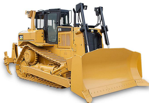
Слика бр. 18: Булдозер CAT D7
