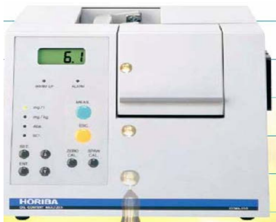
Слика 6.1.3.3.1 IR системи за брзо одређивање присуства угљоводоника у отпаду
