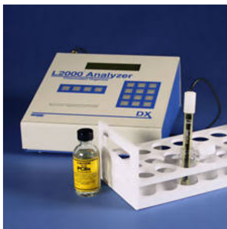
Слика 6.1.3.1.2 Апарат за брзо утврђивање концентрације PCBs (Dexsil L2000 Analyzer)
