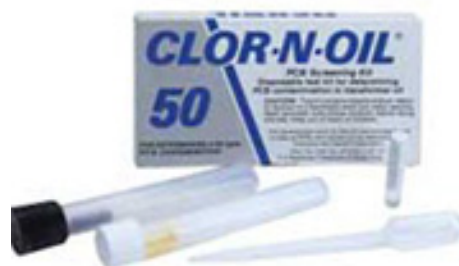
Слика 6.1.3.1.1 PCBs кит за брзо одређивање PCBs
