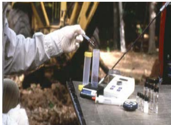
Слика 6.1.3.3.1 IR системи за брзо одређивање присуства угљоводоника у отпаду
