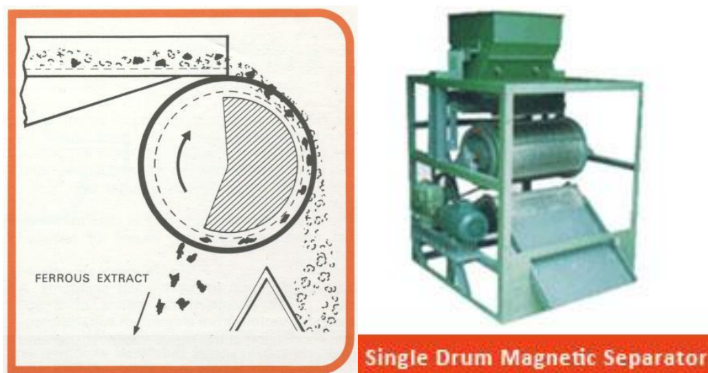
Slika 6. Primer metode i izgleda magnetnih bubnjastih separatora
