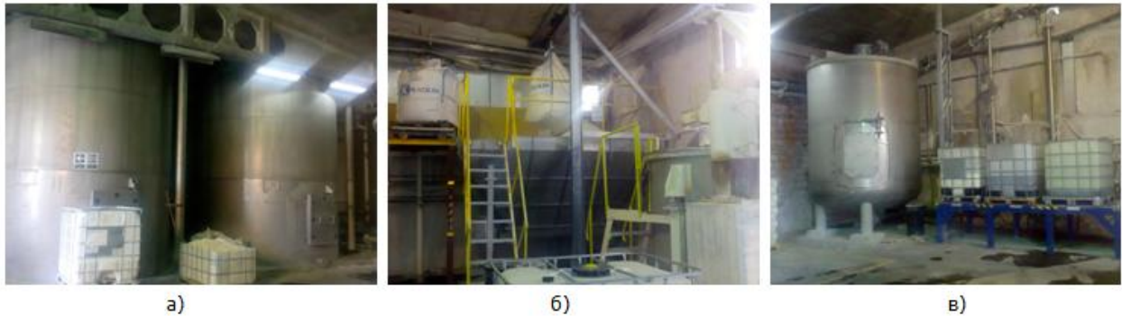
Слика бр. 27: Производно складишни објекат за хемикалије ( а) танкови са Latex-ом, б) млевење Каолина, в) складиштење млевеног Каолина )
