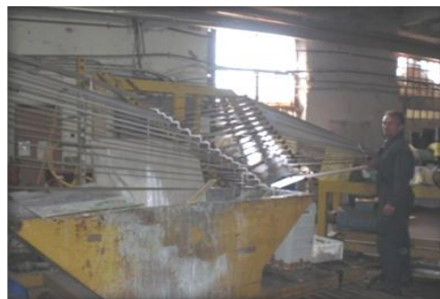
Слика бр.51: Наношење лепка у хилзари
