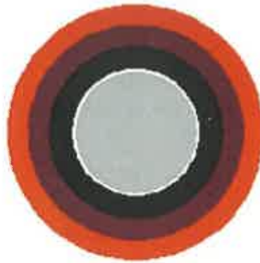
Slika 4.11. Presek Nonel vatroprovodne cevčice
