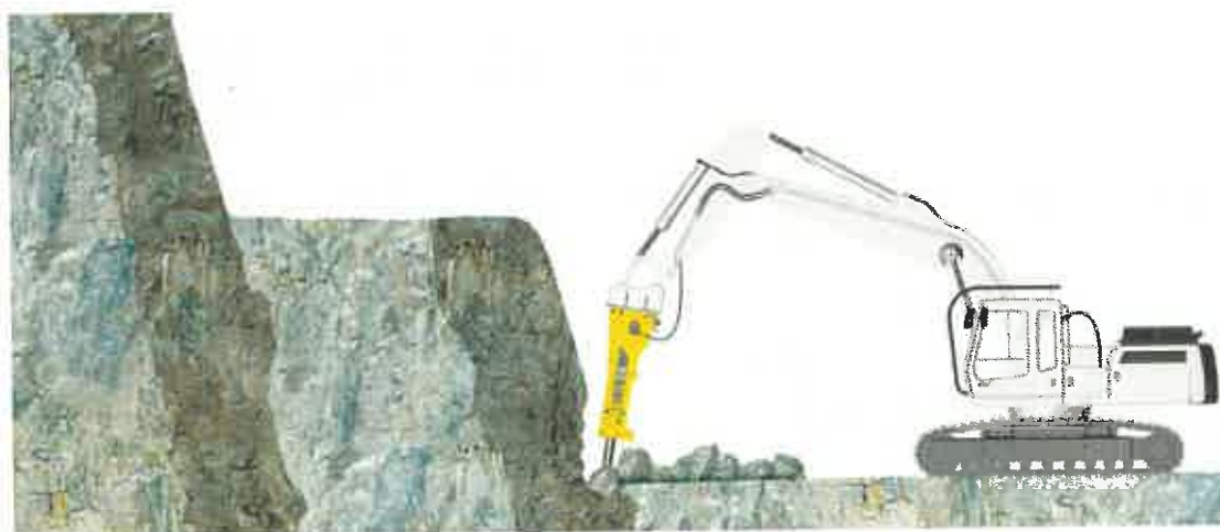
Slika 9.1. Rad bagera kašikara sa hidrauličnim udarnim čekićem
