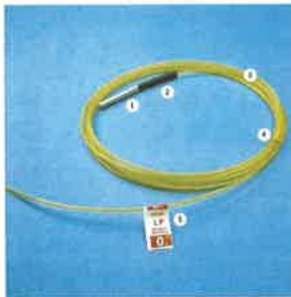
Slika 4.12. Izgled NONEL sistema detonatora
