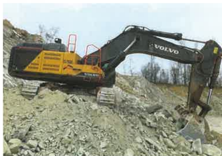
Slika 5.5. Hidraulični bager kašikar Volvo EC750 EL
