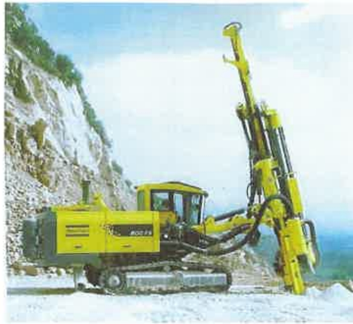
Slika 4.1. Bušilica Atlas Copco ROC F6
