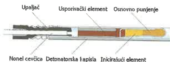
Slika 4.13. Izgled NONEL detonatora
