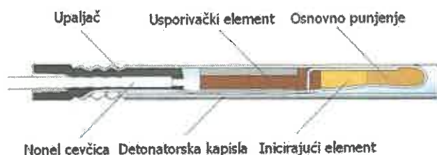
Slika 3.11. Izgled NONEL detonatora
