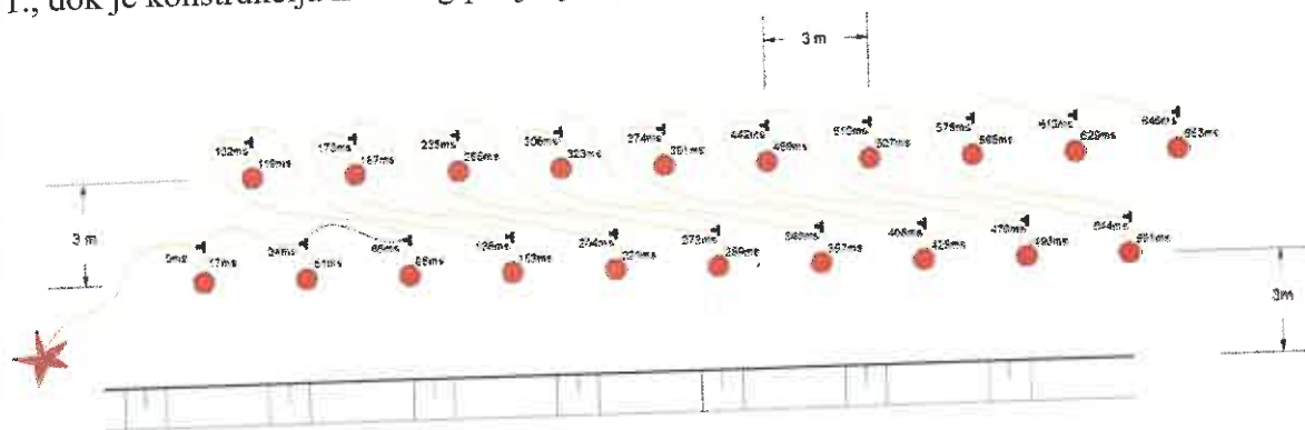
Slika 2.11. Šema iniciranja minskog polja sa razdvojenim minskim punjenjem
