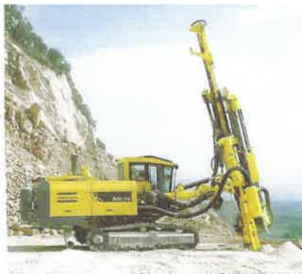
Slika 2.7. Bušilica Atlas Copco ROC F6
