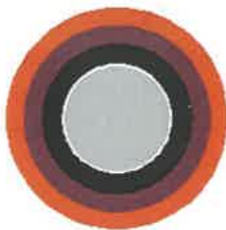
Slika 3.9. Presek Nonel vatroprovodne cevčice
