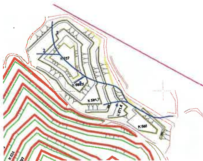
Slika 9.3. Drenažni kanali (1, 2, 3 i 4) ispod odlagališta
