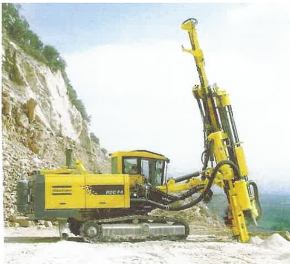
Slika 3.1. Bušilica Atlas Copco ROC F6
