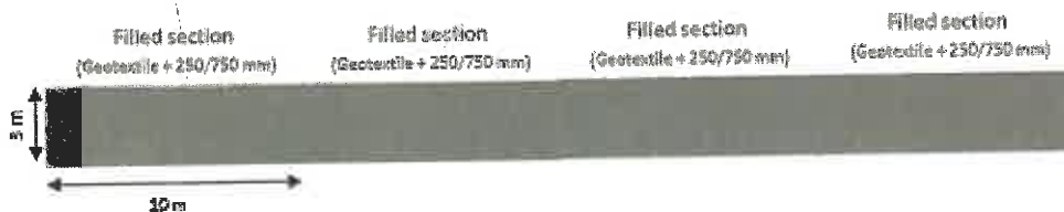
Slika 9.11. Metodologija izrade drenažnih kanala
