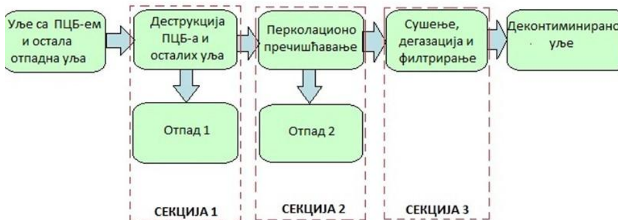
Слика 1. Процес деконтаминације ПЦБ-а и осталих отпадних уља
