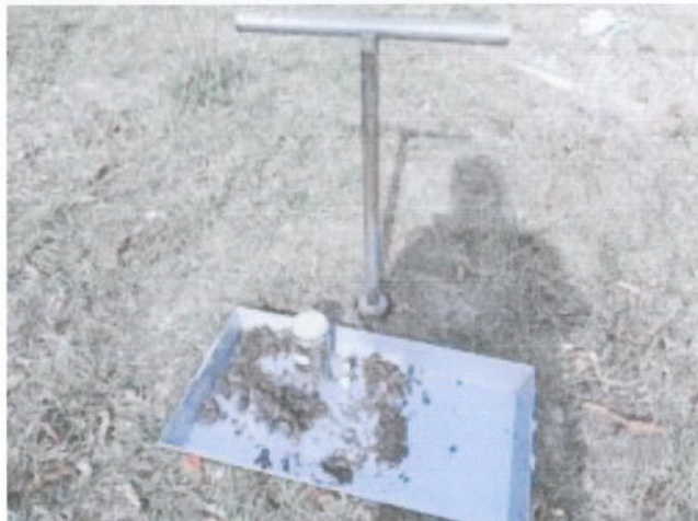
sl 2. uzorkovanje zemljišta na dubini do 30 cm
