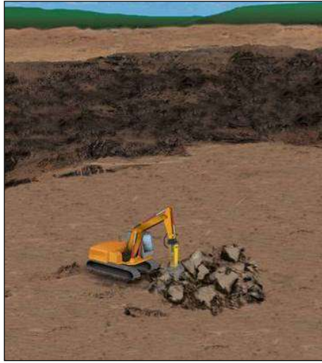
Слика 5. - Уситњавање негабарита механичким ударним чекићем
