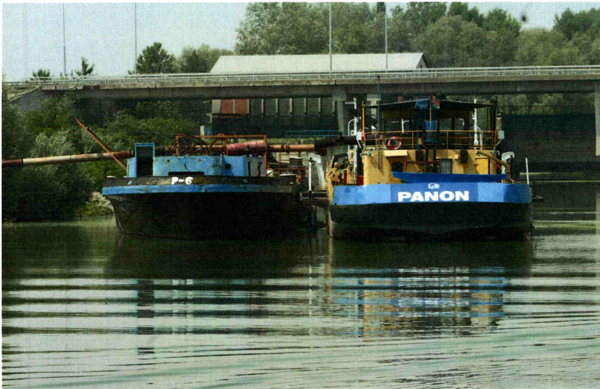
Plovni refulerni bager Mačva za vreme istovara peska
