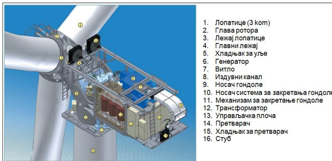
Слика бр. 54: Делови ветрогенератора (ВГ)
