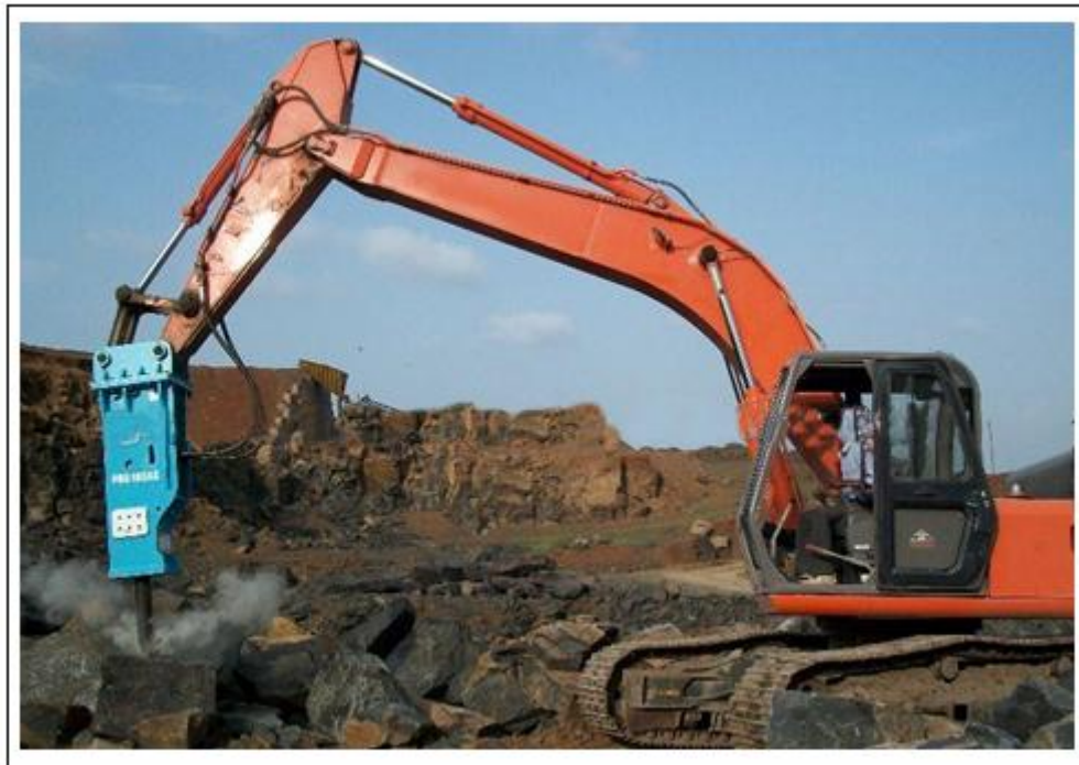
Слика бр. 18: Уситњавање негабарита механичким ударним чекићем
