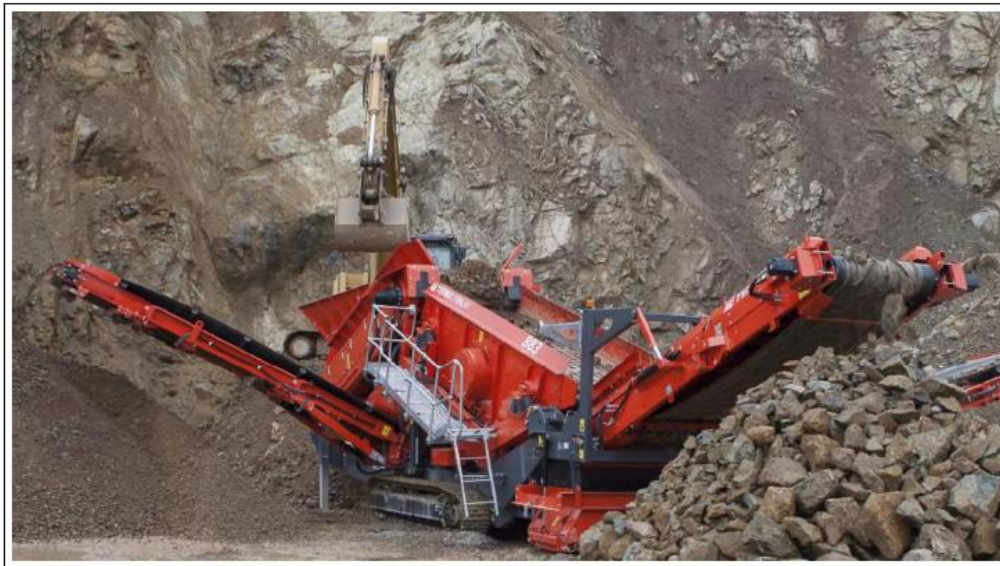
Слика бр. 27: Мобилно постројење за класирање TEREX FINALY 883
