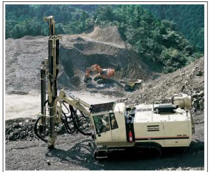
Слика бр. 20: Хидрауличка ударно ротациона бушилица Atlas Copco EMC 585
