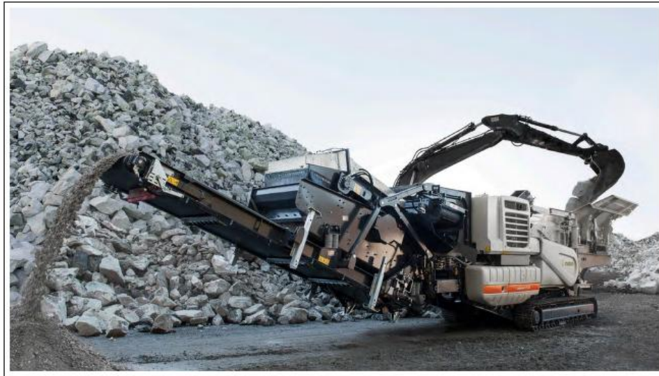
Слика бр. 25: Мобилно дробилично постројење METSO MINERALAS LOKOTRACK LT 1213
