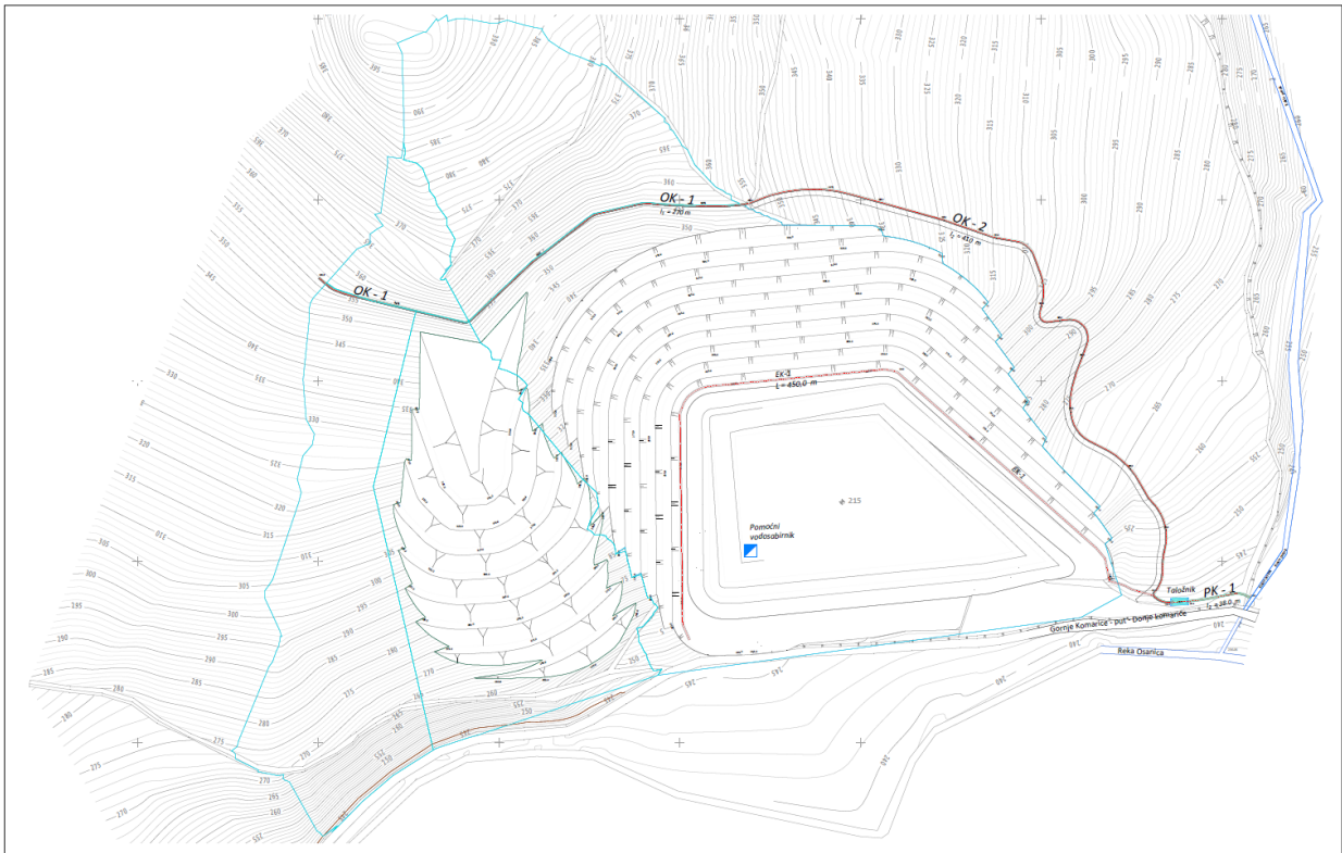
Слика бр. 30: Приказ система одводњавања површинског копа „Комарице“ у завршној фази експлоатације
