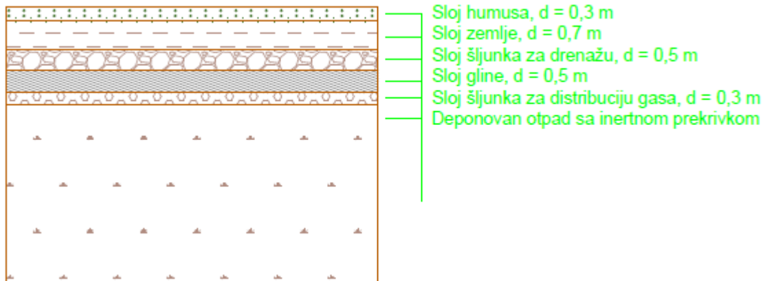
Слика 3.3-2. Приказ завршне прекривке на депонији
