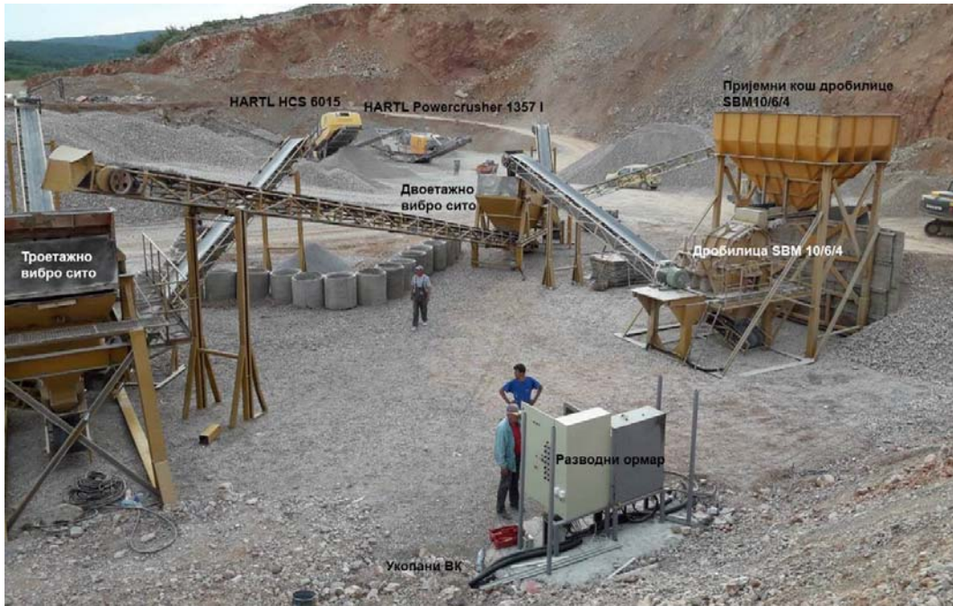
Слика7 Диспозиција опреме на ПК "Крајњи рид" приликом пробног пуштања у рад
