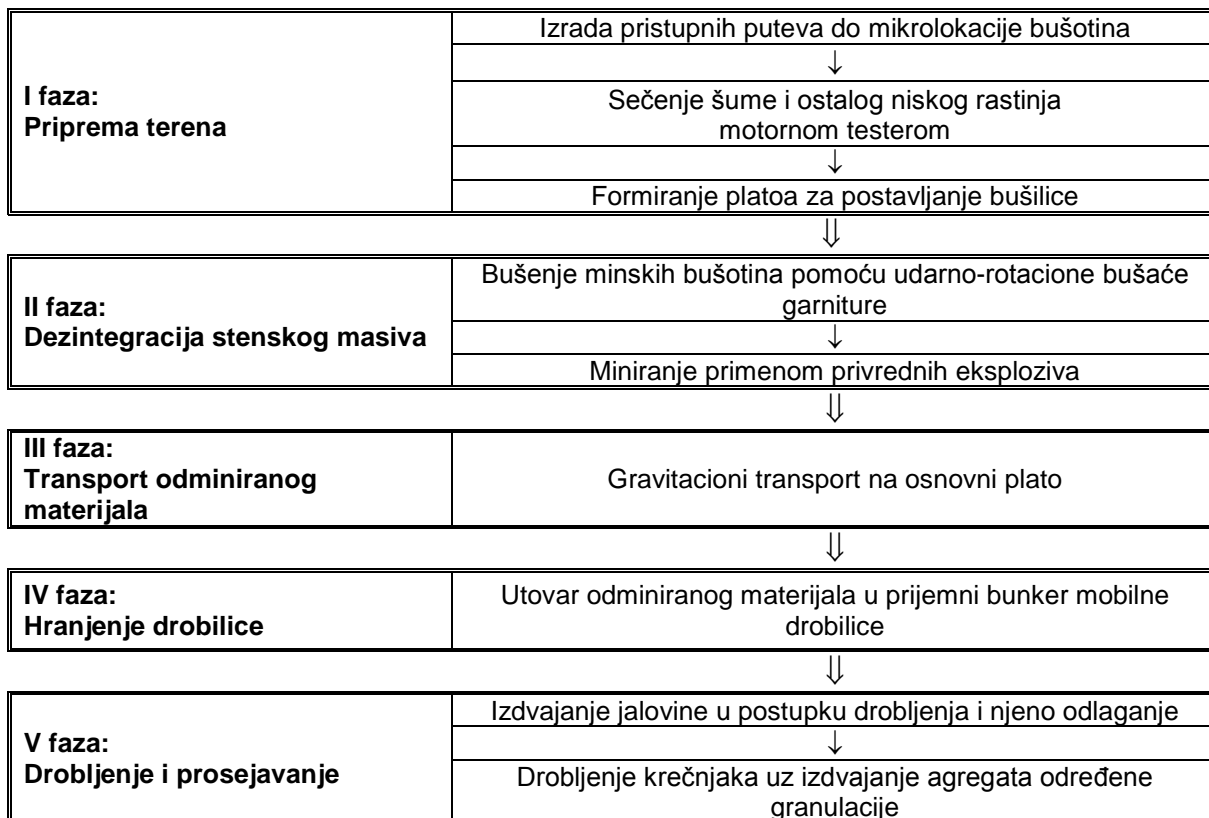
Algoritam 1: Osnovne faze rada na površinskom kopu krečnjaka „Gradac“
