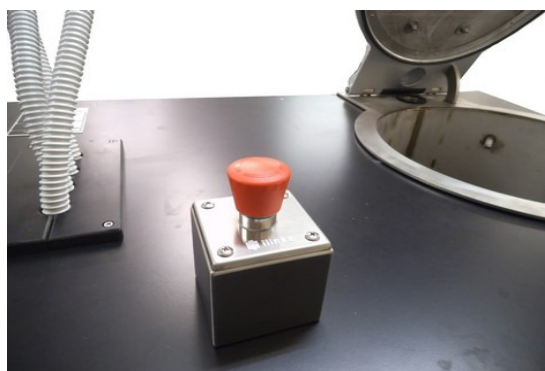
Slika 13. Izgled tipke za slučaj opasnosti
