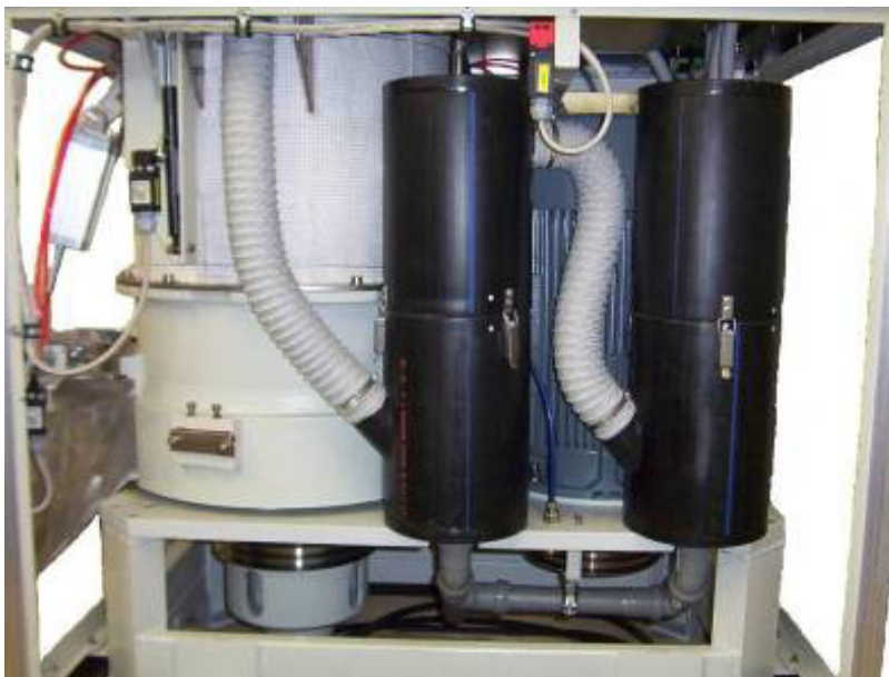
Slika 12. Izgled kolona filtera sa cijevima za provod isparina
