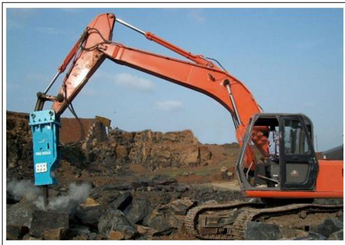
Слика бр. 15: Уситњавање негабарита механичким ударним чекићем (Извор: ГРП)
