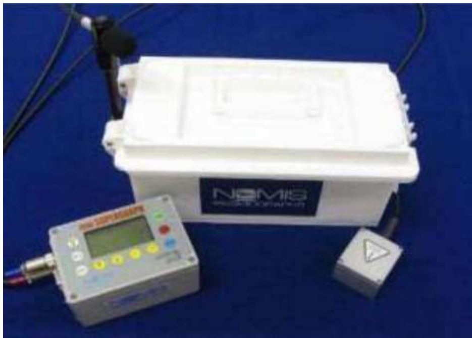
Слика 9-2. Сеизмограф Mini SuperGraph
