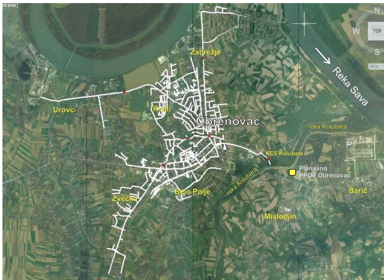
Слика 14. Прегледна ситуација Обреновца са постојећом мрежом канализације за употребљене воде и положајем планираног ППОВ Обреновац.
