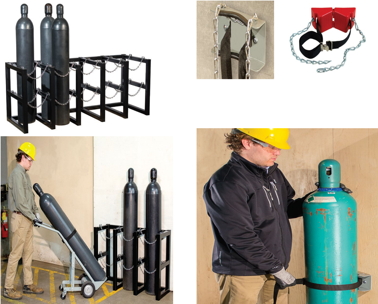
Sl. Br.8. Fotografije o načinu manipulisanja i fiksiranja boca pod pritiskom
