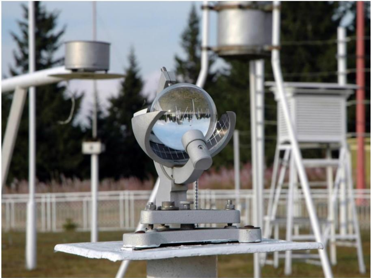
Слика бр.1: Хелиограф, инструмент за мерење дужине трајања Сунчевог зрачења, саставни је део Метеоролошке станице на Копаннику
