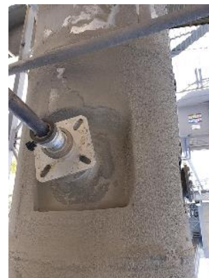
Отпращивач транспортера силоса клинкера 1
