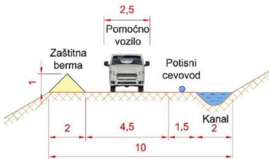
Slika 3.8 – Geometrijski elementi servisnog puta
