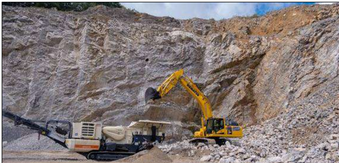
Слика 8. – Утовар багером у мобилно дробилично постројење (Извор: ГРП Заблаће)
