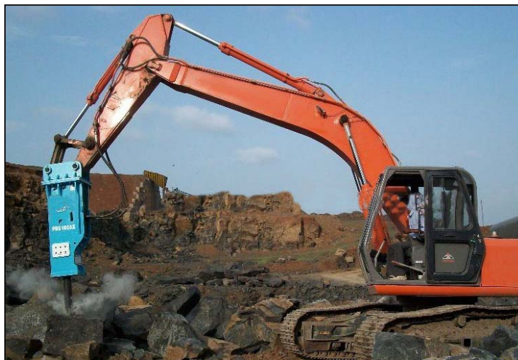
Slika 2.2. Usitnjavanje negabarita mehaničkim udarnim čekićem
