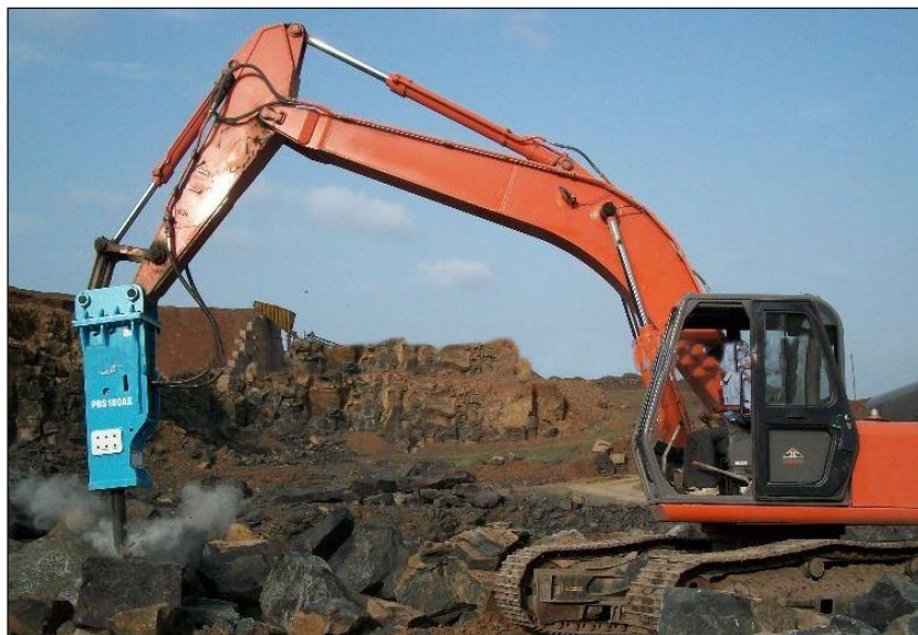
Слика 14. – Уситњавање негабарита механичким ударним чекићем
