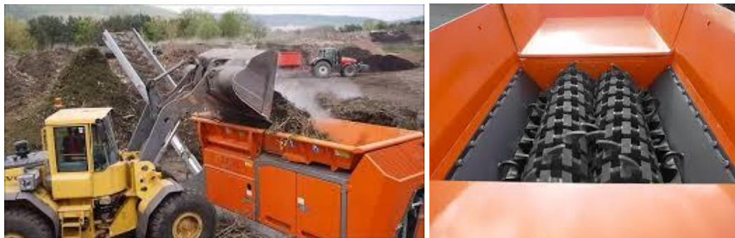
Слика 3. Усипни кош дробилице и радни ножеви
