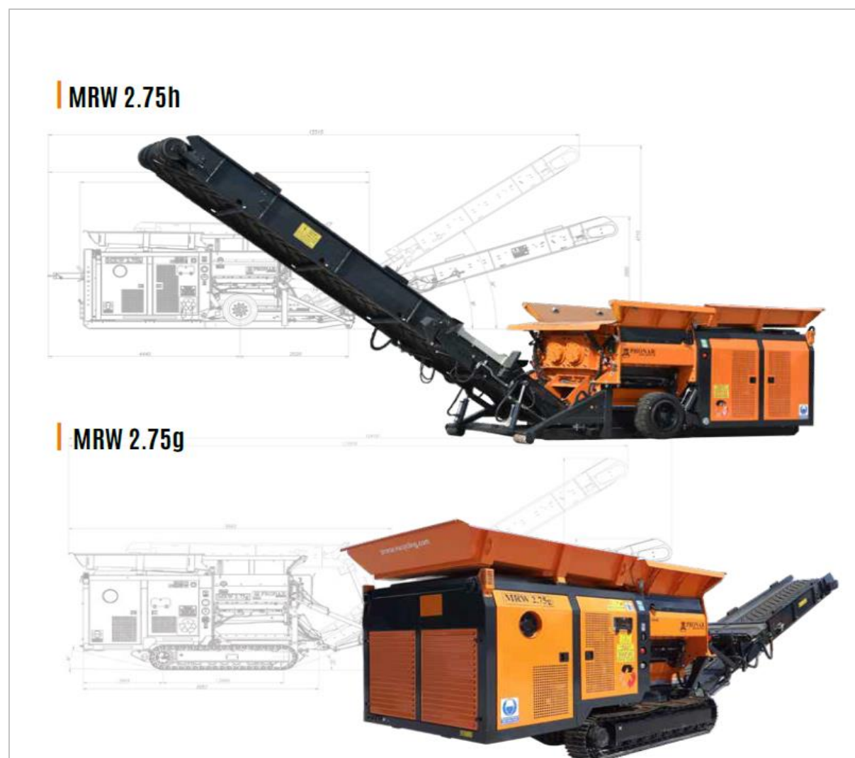
Слика бр.7: Изглед мобилног постројења за третман неопасног отпада тип „PRONAR MRW 2.75g“
