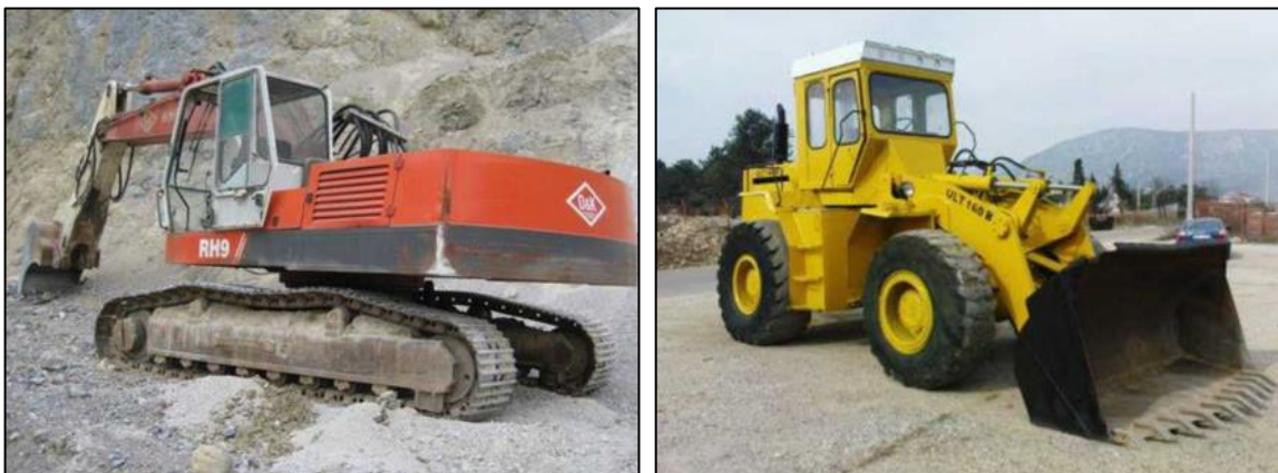
Слика 19. – Изглед хидрауличног багера ОК RH9 (лево) и изглед утоваривача ULT160 (десно)
