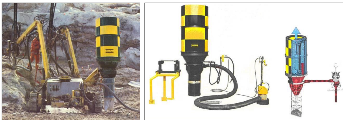
Слика 21. – Отпрашивач DCD 90 са филтером и сувим циклоном у раду
