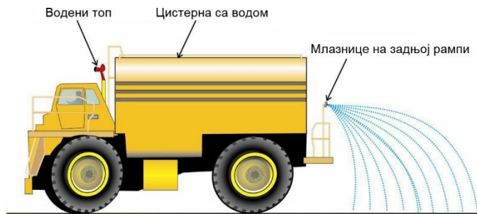
Слика 23. – Аутоцистерна опремљена пумпом, предњим топом и задњом рампом са млазницама
