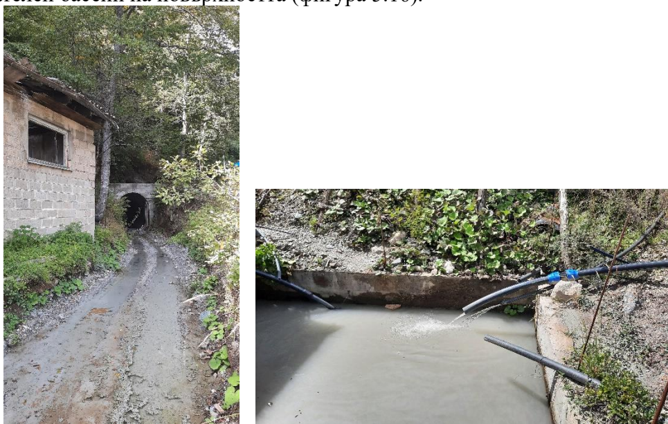
Фигура 5.16 -а Изтичане на води от мината от IV хоризонт пред утайника; б Събирателен басейн на ниво V хоризонт
