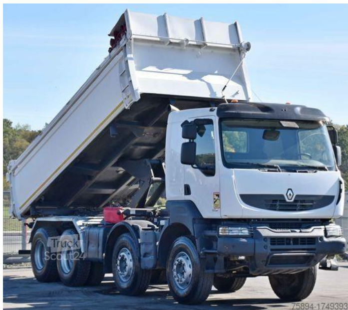
Слика бр. 12: Камион кипер RENAULT KERAX 450.42 8x4
