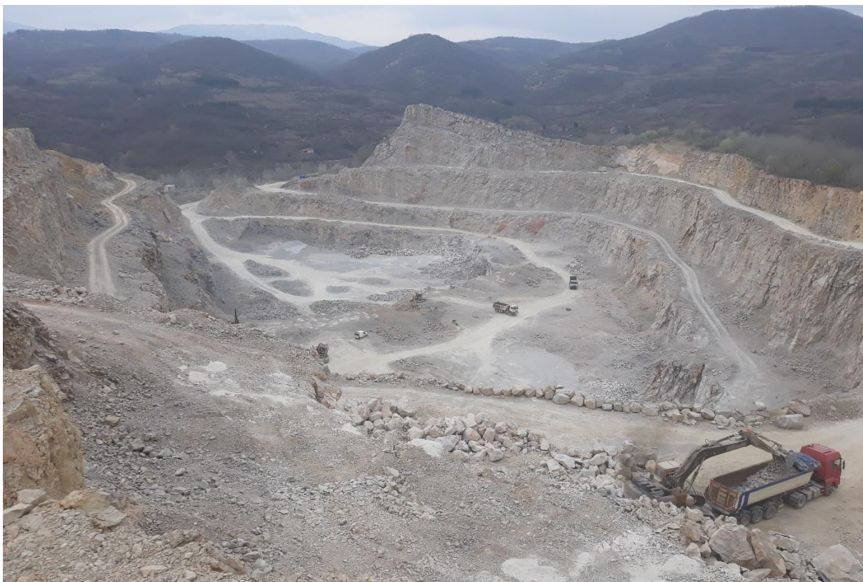
Слика бр. 10: Изглед транспортних путева на ПК Долац и утовар одминираниог кречњака у транспортно средство (Извор: ГРП)
