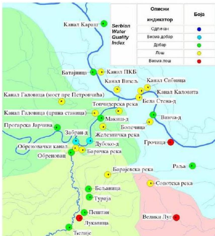
Merna mesta vodotokova na teritoriji Beograda sa prosečnim vrednostima indikatora SWQI za 2010 godinu
