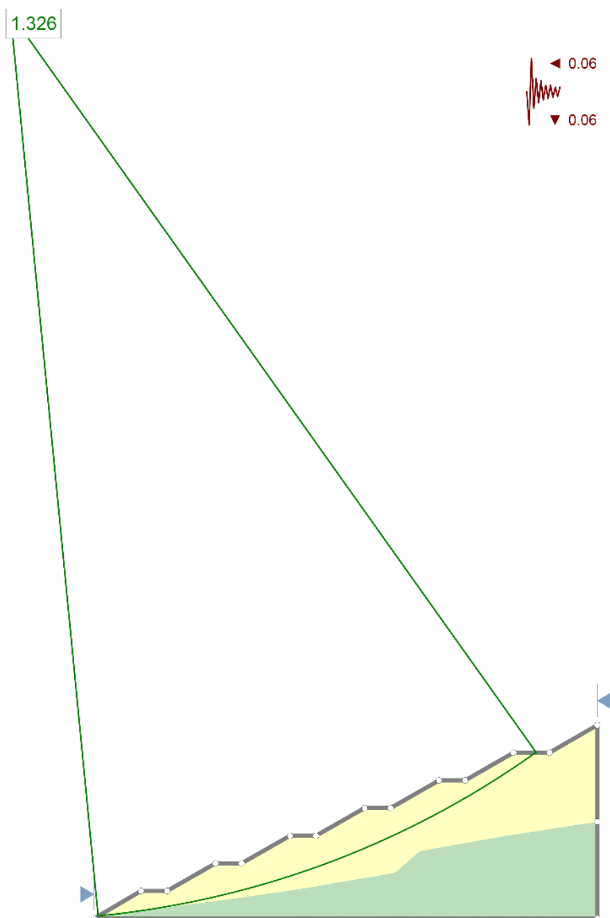
Slika 1.5. Grafički prikaz analize stabilnosti završne kosine severozapadnog odlagališta na karakterističnom profilu P1
