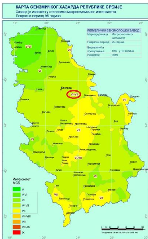
Слика бр. 7: Сеизмолошкој карти за повратни период од 95 година (Извор: Републички сеизмолошки завод Србије)
