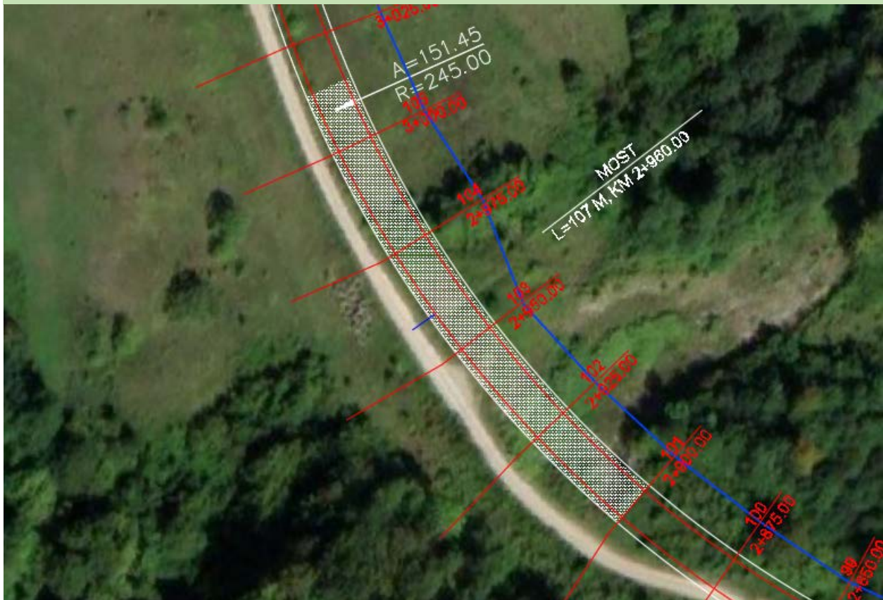
Слика 54 - Пролаз испод вијадукта на km 3+925,00
