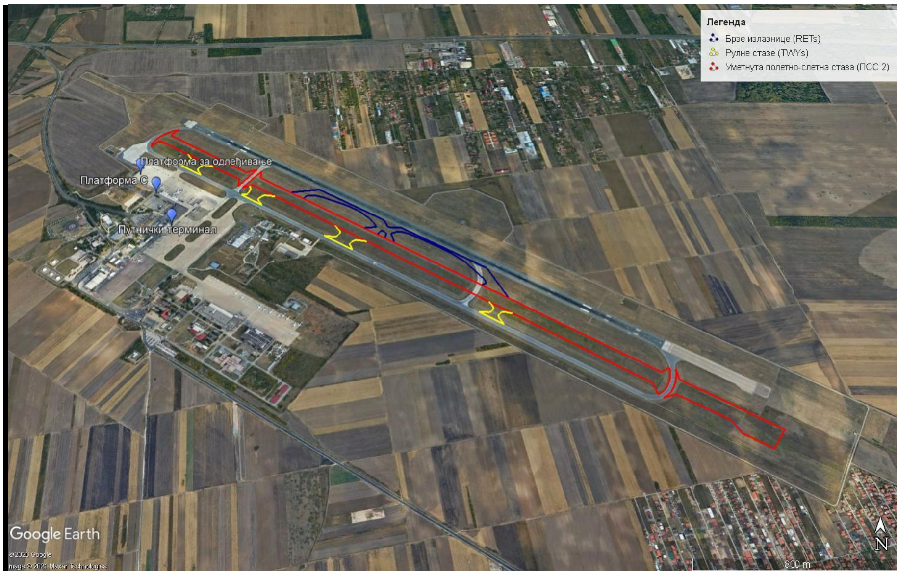
Слика 5 Микролокација пројекта нове уметнуте полетно-слетне стазе, рулне стазе за брзи излазак и рулних стаза (извор: Google Earth)
