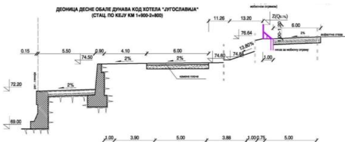
Попречни пресек обалоутврде са планираним мобилним системом
