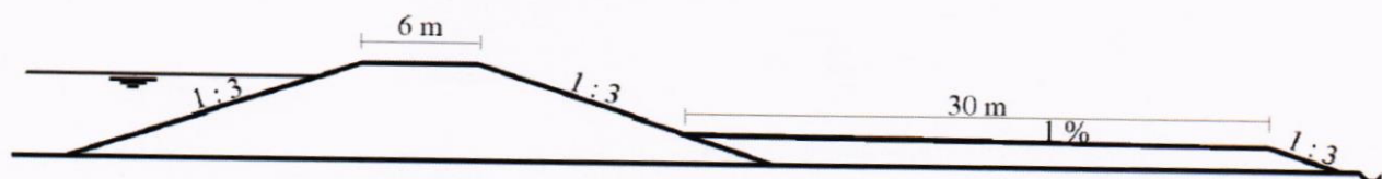
Слика 3. Карактеристичан попречни пресек савског насипа на предметном потезу
