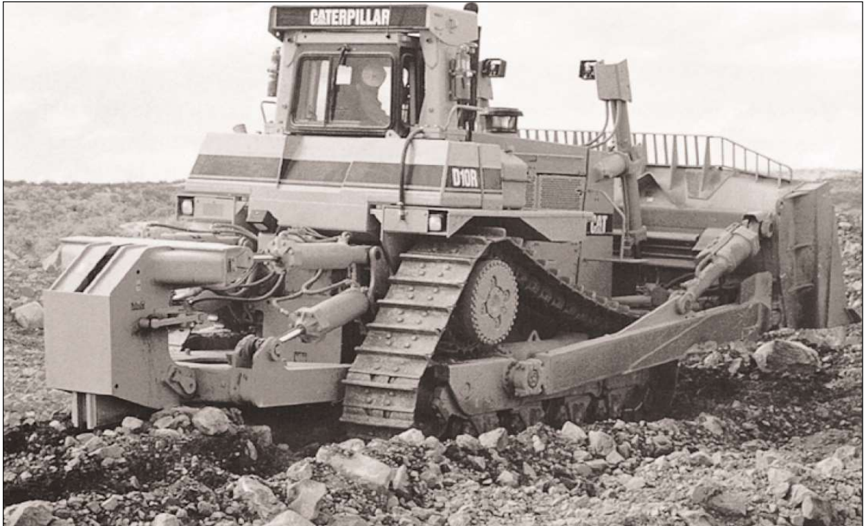
Слика 5. Правилна позиција булдозера у процесу риповања
