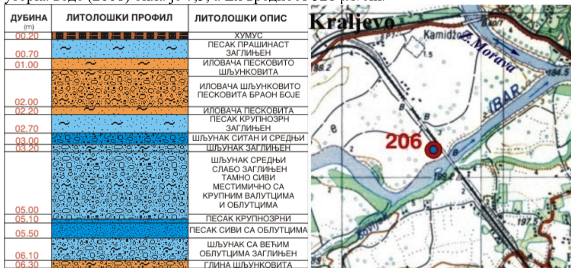
Слика 2.9: Литолошки стуб бушотине на локацији Краљево – река Ибар (Републички хидрометеоролошки завод Србије)
