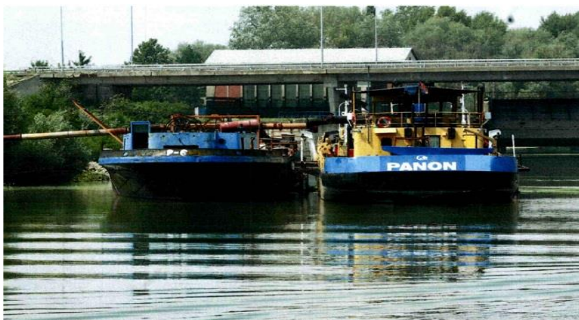
Слика 7. Рефулерни багер хопер «Панон» за време истовара песка
