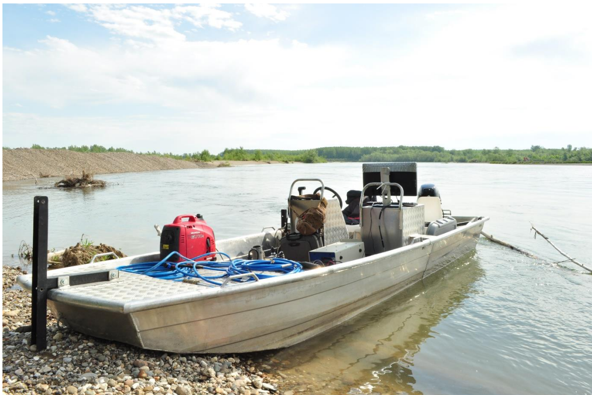
Slika 3. Aluminijumski čamac za hidrografsko merenje
