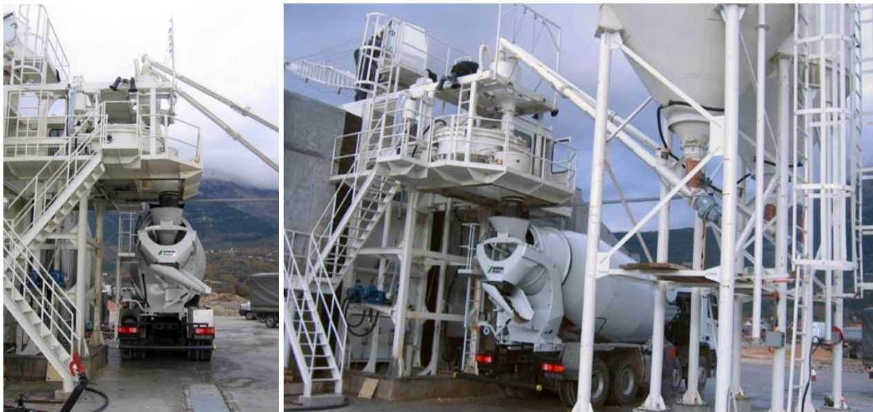
Слика 10. Фабрика бетона Прогрес капацитета 50 м 3 /часу
